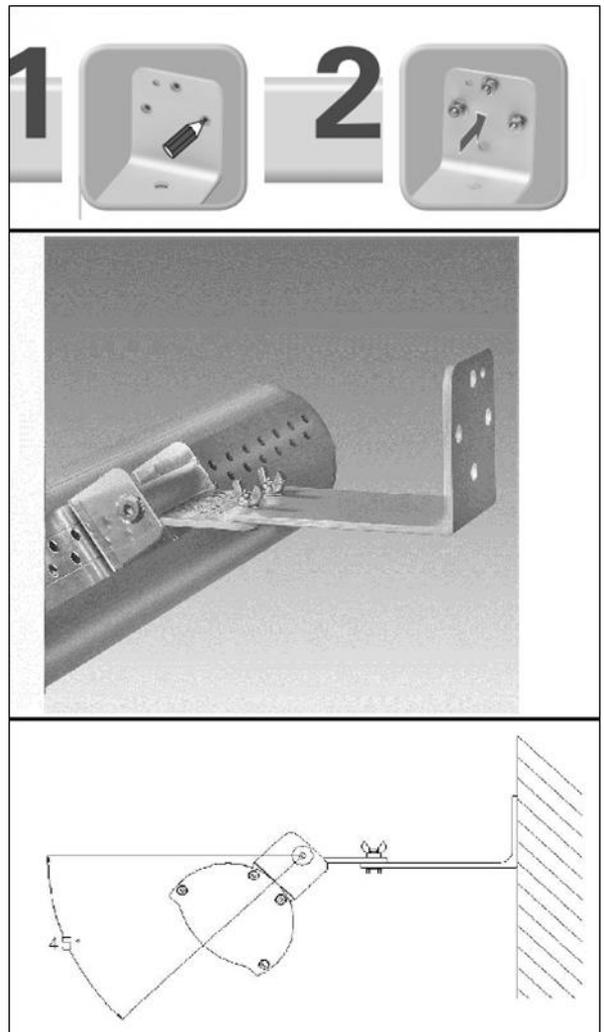
Indstil apparatets ønskede strålevinkel. Apparatet kan drejes 115°, fra skråt opad til næsten lige nedad. Vær ved indstilling af retningen opmærksom på, at apparatet ikke rettes mod brandbare materialer med for kort afstand. Det anbefalede antal grader til monteringsvæggen er 45°, se fig.
