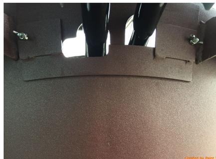
Schrauben Sie den Gasschlauch am Brenner ab und ziehen Sie ihn durch die Öffnung zurück.
