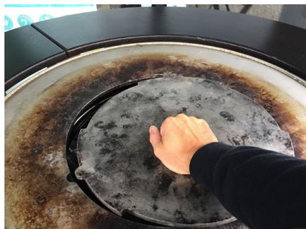
Lösen Sie die beiden Flügelmutter von den Brennraumplatten, welche die Rohre des Gasbrenners an den Bedienknöpfen umgeben.
