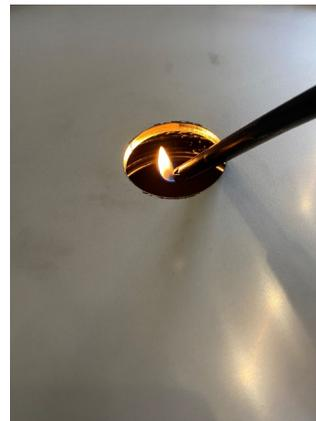
Verwenden Sie ein Stabfeuerzeug in der Öffnung der Grillplatte. Kontrollieren Sie, ob der Brenner richtig gezündet hat, und schalten Sie dann den anderen Brenner nach Bedarf ein, indem Sie den rechten Drehknopf nach links drehen.
