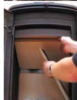
4. Nadat de zijplaten zijn verwijderd, laat u het onderste rookschot zakken en tilt u dit eruit.
