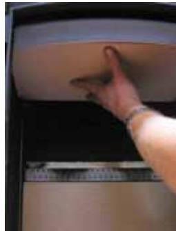
6. Après un nettoyage, assurez-vous que les chicanes pour la fumée et les briques sont à nouveau correctement montées avant d'allumer votre poêle.
