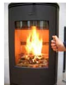
5. Un chauffage normal s'effectue alors qu'il reste encore des braises. Répartissez les braises au fond et surtout sur le devant du poêle.
