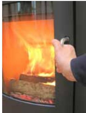
8. Baissez ensuite l'air de combustion sur la position désirée pour assurer une combustion optimale.
