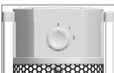
Zariadenie potom spusťte prepnutím ovládacieho tlačidla do polohy I (450 W, polovičný výkon) alebo II (900 W, plný výkon). Ak chcete zariadenie vypnúť, prepnite tlačidlo do polohy 0 a vytiahnite zástrčku zo zásuvky. Nechajte ohrievač vychladnúť.
