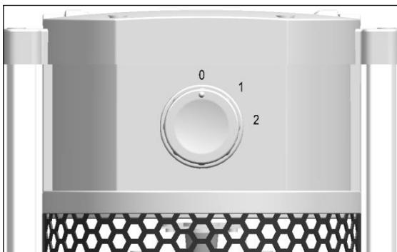
Sie schalten Ihren Heizstrahler ein, indem Sie den Bedienungsknopf auf I (450W, halbe Leistung) oder II (900W, volle Leistung) stellen. Um das Gerät auszuschalten, drehen Sie den Knopf auf 0 und ziehen Sie den Stecker aus der Steckdose. Geben Sie dem Gerät genügend Zeit zum Abkühlen.
