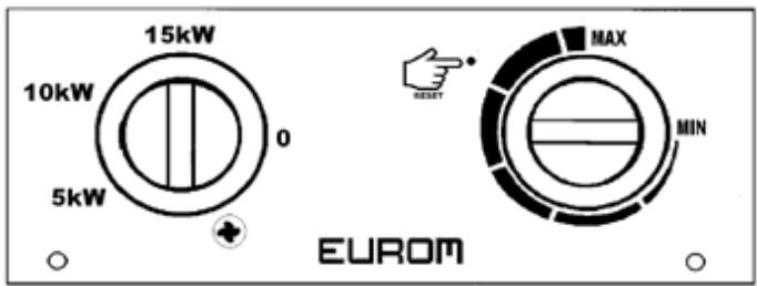
Im Bedienungspult des EK9002 und EK15002 befindet sich auch noch das Reset-Loch (siehe: Sicherungen).
