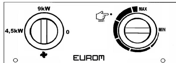
\* À droite, le bouton de thermostat à réglage progressif.
