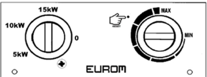
Pe panoul radiatoarelor de tip EK9002 și EK15002 se găsește de asemenea și punctul de resetare (a se vedea caracteristici de siguranță).
