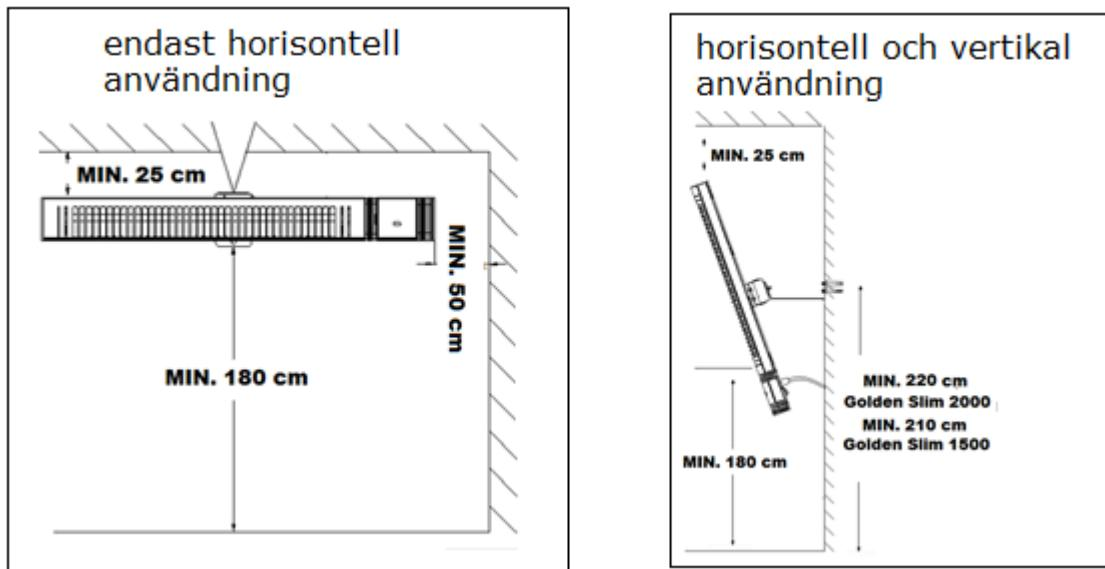
Infravärmaren Golden Slim är utrustad med ett vridbart väggfäste så att den kan användas både horisontellt och vertikalt. Det krävs särskild uppmärksamhet vid installationen eftersom man måste ta hänsyn till minimiavstånd till vägg, tak och golv i alla möjliga lägen:
