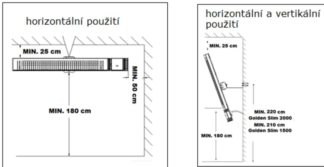
Infračervený zářič Golden Slim je vybaven otočnou stěnovou konzolou, takže jej lze použít v horizontální i vertikální poloze. To však vyžaduje zvýšenou pozornost při instalaci, aby byla ve všech možných montážních polohách dodržena minimální vzdálenost od stěny, stropu a země:
