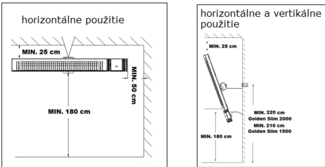
Infračervený ohrievač Golden Slim je vybavený otočným nástenným držiakom, aby bolo možné horizontálne, ako aj vertikálne použitie. Vyžaduje to zvýšenú pozornosť pri inštalácii, lebo vo všetkých možných polohách zariadenia je potrebné počítať s minimálnymi odstupmi od steny, stropu a podlahy.
