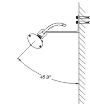
Infrarotstrahler.) Die kurze Seite der Wandhalterung wird dabei nach oben gerichtet am Untergrund befestigt (siehe Abb.).
